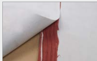
ELMCO–Sperrfolie-Vlies, geprüfte Verklebung der Stöße
