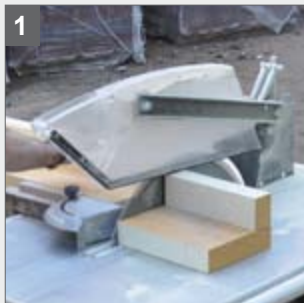
1 Zuschneiden der Zargen
