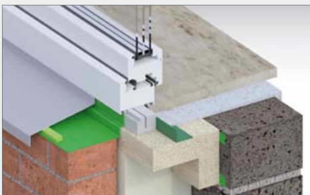
„Vorwandmontage-System Typ 3“ – für 120 - 200 mm Ausladung
