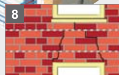
Sanierung gebrochener Massiv-Mauerstürze
